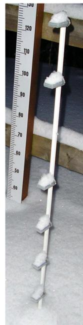
Abbildung 1: Temperatursensoren zur Messung des Schneetemperaturprofils.
