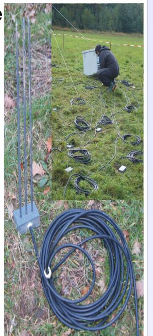
Abbildung 3: S-TDR-Auslage am Hang mit Instrumentenkiste und Dreistabsonde mit 60 cm Stäben
